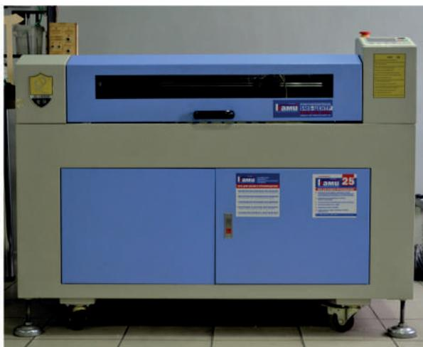
Станок, предназначенный для лазерной гравировки и резки.
