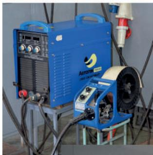
Полуавтомат AMIG-500 предназначен для интенсивной полуавтоматической дуговой сварки на токе до 500А в среде защитного газа (Co2). Выполнение сварки в нижнем и вертикальном положениях, производить наплавку слоев металла под проточку. Металлоконструкции без допуска к работам на конструкциях повышенной сложности. В лаборатории имеются 3 поста для полумеханизированной сварки.
